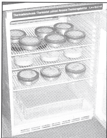
Rys. 3. Metoda grawimetryczna, miseczki w komorze klimatyczne Fig. 3. Cup-method experiment in a climatic chamber
